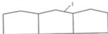
图 4.2.2-5 多跨双坡屋面风荷载系数分区 1—每个双坡屋面分区按图 4.2.2-4c 执行
