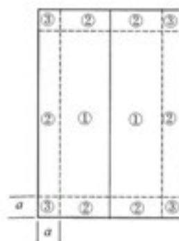
图 4.2.2-4a 双坡屋面和挑檐风荷载系数分区 ( 0^\circ \leq \theta \leq 10^\circ )
