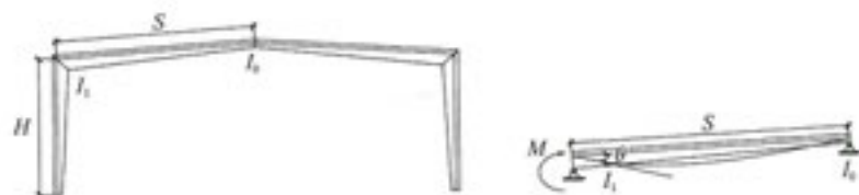
图 A. 0. 3-1 刚架梁为一段变截面及其转动刚度计算模型
